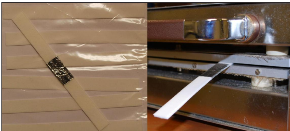
شکل ۲ نمایی از چگونگی آماده سازی نمونه برای گرفتن آزمون مقاومت کششی ورق کاغذ تر پیش از فشردن و خشک شدن [۱۱]
