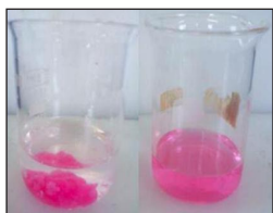
شکل ۱۰ لخته‌های به‌دست آمده از فرایند لخته سازی برای سرخ کاتیونی
