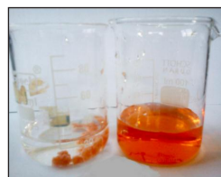
شکل ۹ لخته‌های به‌دست آمده از فرایند لخته سازی برای قهوه ای آنیونی
