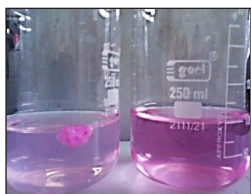
شکل ۱۱ لخته‌های به‌دست آمده از فرایند لخته سازی برای رز بنگال
