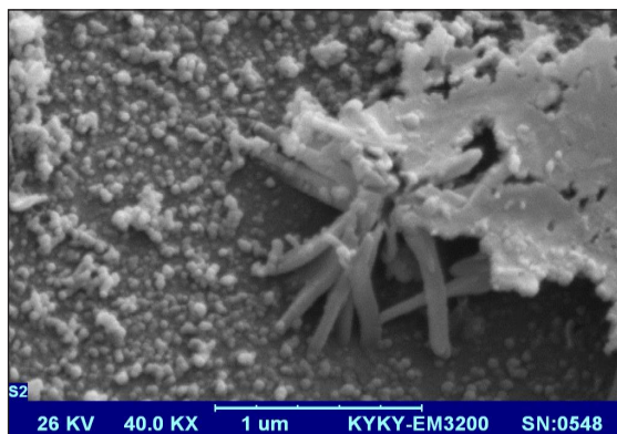
شکل ۳ نانو میله روی اکسید در pH برابر با ۹٫۵
