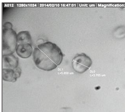
شکل ۳ تصویر میکروسکوپ نوری میکروکپسول تهیه‌شده (HD@MF)
